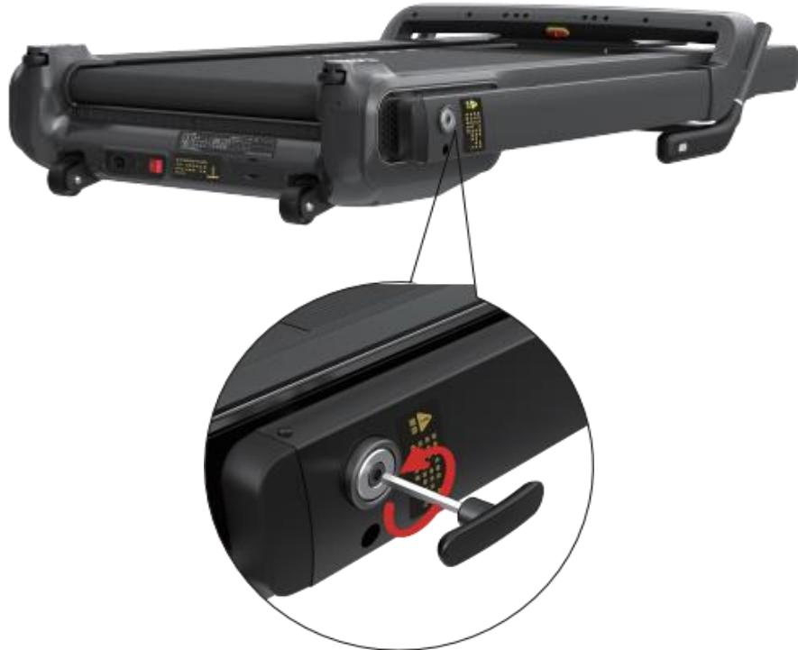
Как показано на рисунке, с помощью ключа (57) ослабьте два винта M8\*105 с левой и правой стороны беговой дорожки (по 5-6 оборотов с каждой стороны), чтобы поднять вертикальную стойку.
